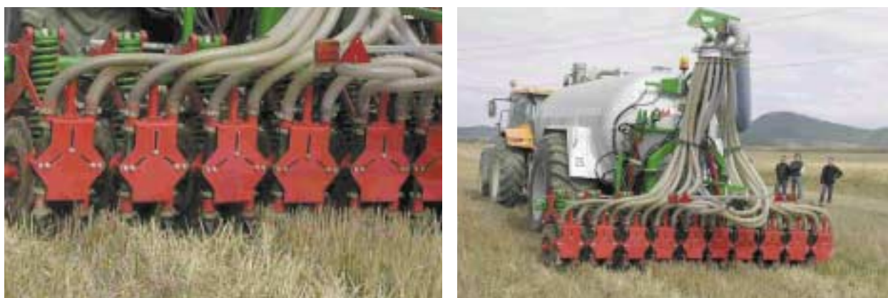
Figura 6. Aplicación de purín mediante inyección
