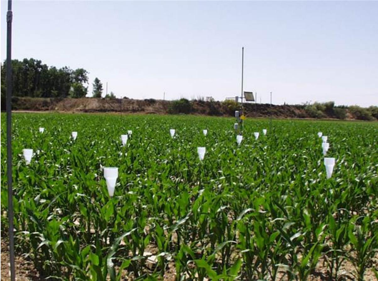
*Foto 2. Vista de uno de los sectores en los que se midió las pérdidas de agua por evaporación y arrastre y la uniformidad del riego.*
