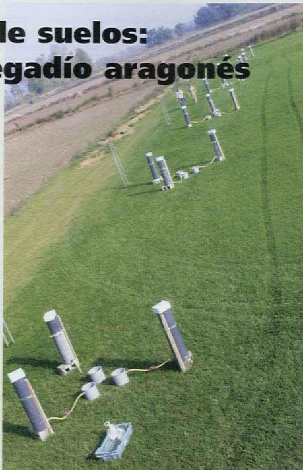
Infiltración. Medida de la infiltración del agua en el suelo en un campo de alfalfa.
