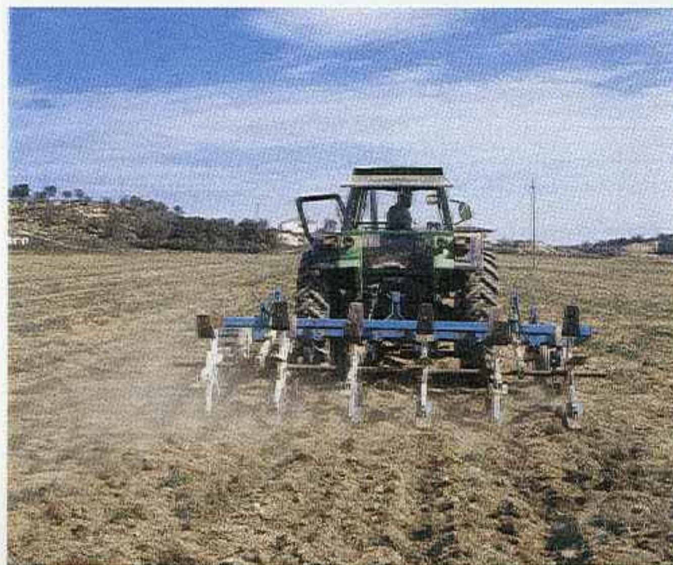
El empleo del «chisel», unido a bacheadores de paletas, reduce la erosión y mejora la capacidad de infiltración del suelo.
