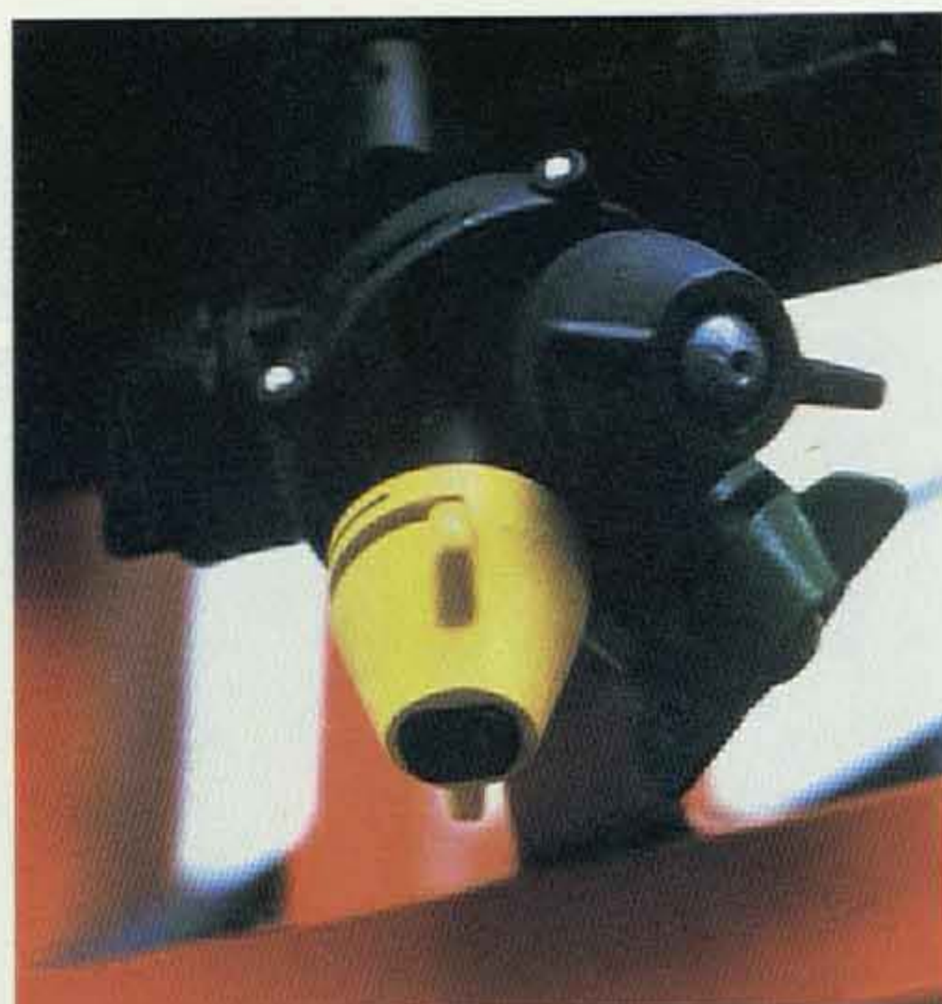
El empleo de portaboquillas de bayoneta garantiza la posición del plano de pulverización de la boquilla y facilita el mantenimiento.
