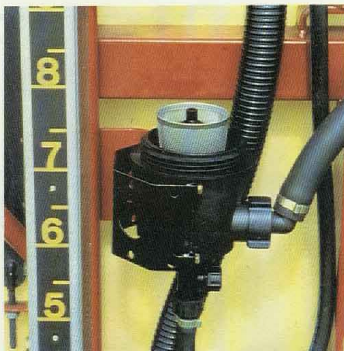
La filtración del caldo impide que se produzcan obstrucciones en las boquillas.
