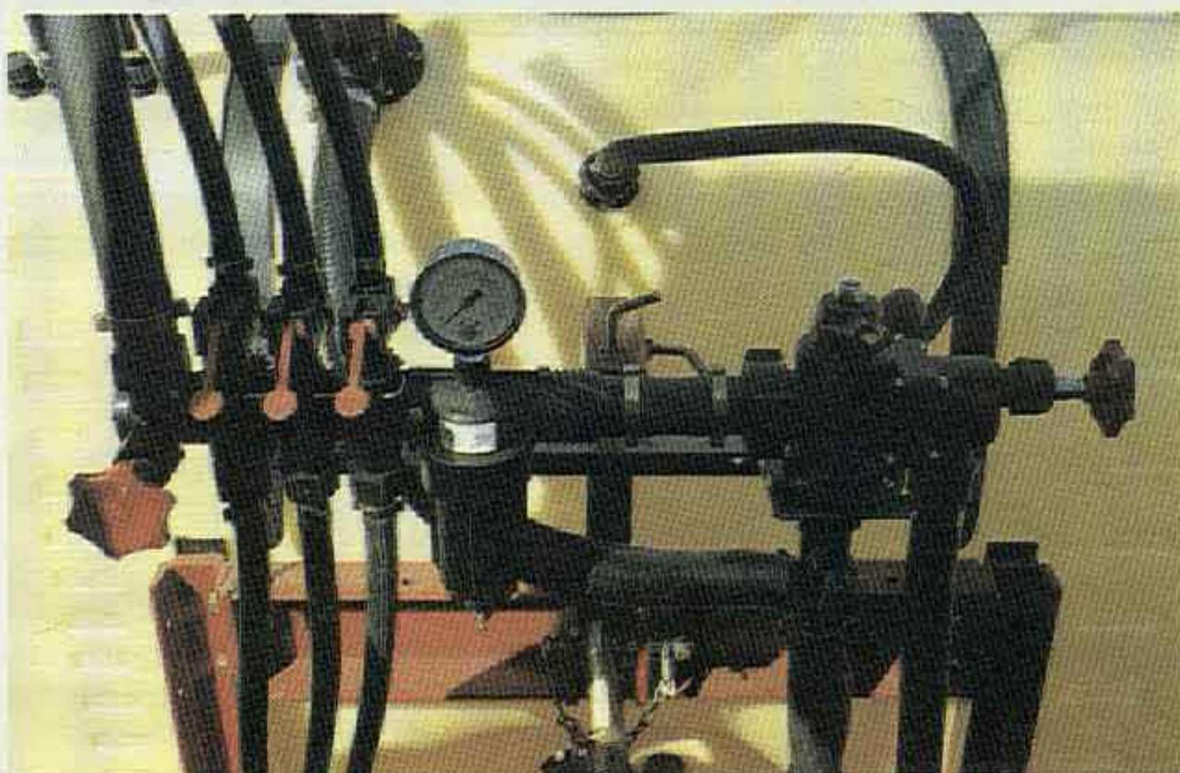
La grifería y el sistema de regulación, incluido el manómetro, garantizan que la presión de trabajo de las boquillas se mantenga constante.
