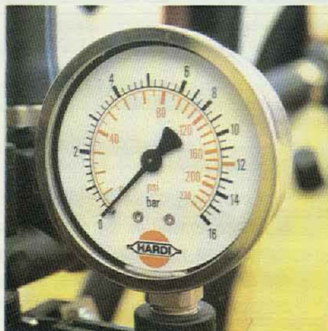
La grifería y el sistema de regulación, incluido el manómetro, garantizan que la presión de trabajo de las boquillas se mantenga constante.
