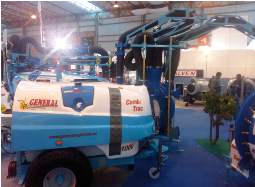
Pulverizador hidroneumático, de salidas múltiples dirigidas, instaladas en la parte delantera de la máquina, entre tractor y equipo
